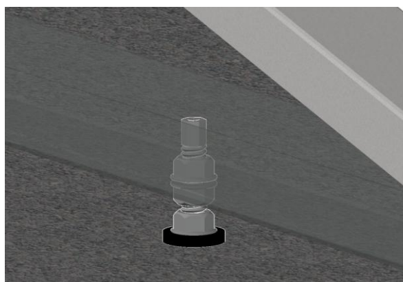
Rys. Detal zmontowanej śruby z podstawą trójkąta
